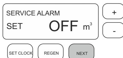
Jeśli chcesz aby Twoje urządzenie przypomniało o zaplanowanych pracach serwisowych po przepłynięciu odpowiedniej ilości wody, włącz powiadomienie serwisowe (zakres 100 - 50000 m<sup>3</sup>). Producent zaleca pozostawienie tej opcji wyłączonej - tryb OFF.
