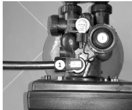
1. Schrauben Sie den Schlauch auf die Anschlüsse (1), es ist sicher zu gehen, dass der Schlauch am Ende mit einem Steifeinsatz versehen ist.
