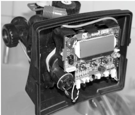
2. С особой осторожностью поддеть защелки (см. фото). Осторожно отодвигая, вынуть элемент, на который крепится контроллер.
