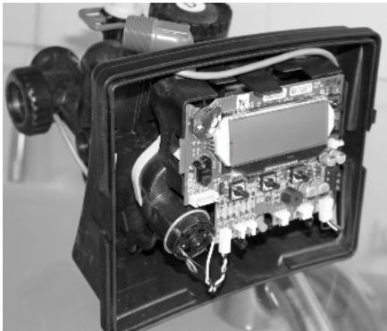
2. Mit besonderer Vorsicht sind die Klinken hochzuheben (am Foto zu sehen). Leichtes Abschieben ermöglicht das Herausnehmen des Elements, auf dem die Steuerung platziert ist.
